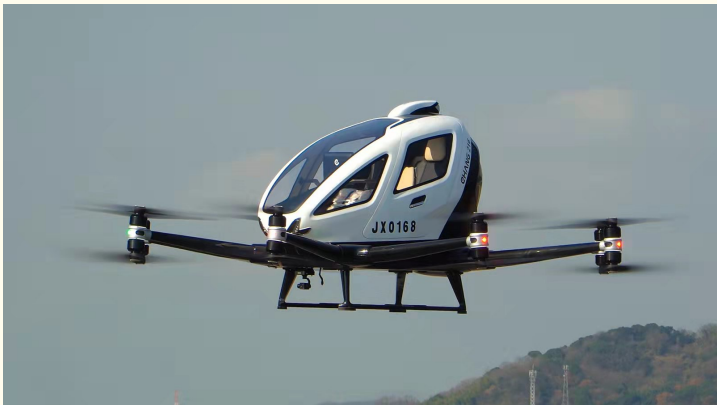
マルチコプター型の空飛ぶクルマ (出典は中国Ehang社のニュースリリース)
