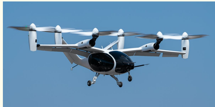
推力偏向型の空飛ぶクルマ (出典は米国Joby Aviation社のニュースリリース)
