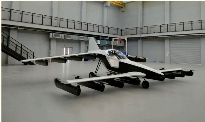
リフト・クルーズ型の空飛ぶクルマ (出典は我が国のテトラ・アビエーション社のHP)
