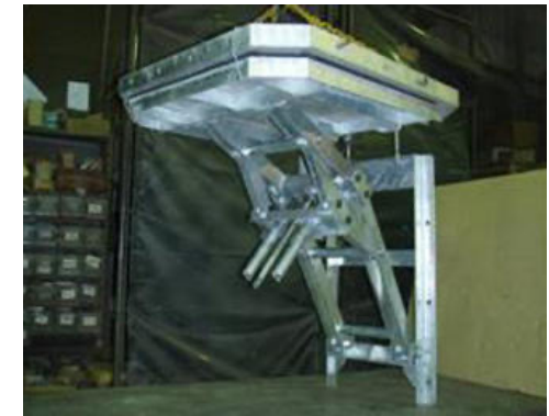
トンネル坑口の防水ゲート(上) 換気口用浸水防止機(下)
