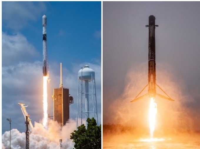
ファルコン9の打上げと第1段ロケットの軟着陸 (出典は米国スペースX社のLinkedIn投稿画像)
