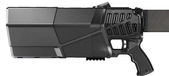
DroneGun Mk3(出典: オーストラリアDroneShield社のHP) 各ISM Bandと各GNSS Bandに有効、最大射程約0.5km 重量約2.1kg、最長2時間の運用可能、IP55
